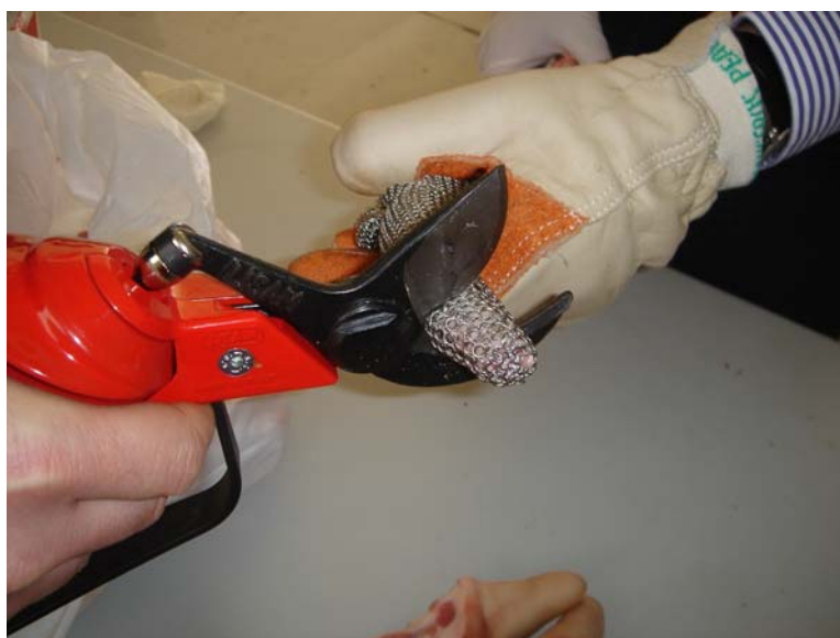
Figura 43. Corte a 12 bares de presión.
