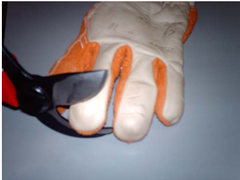
Figura 60. Ensayo con dediles metálicos.
