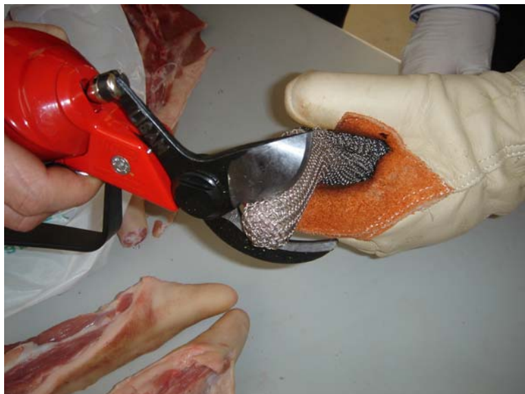
Figura 47. Tijera realizando un corte a 14 bares.
